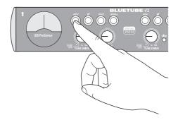
Sprechen Sie in das Mikrofon und behalten Sie das frontseitige VU-Meter im Auge. Drehen Sie den GAIN-Regler von Eingang 1 allmählich nach rechts.
