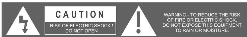
Эмблема молнии в равностороннем треугольнике означает предупреждение пользователю о наличии незаизолированного опасного напряжения в продукте, которое может привести к риску удара электрическим током.
