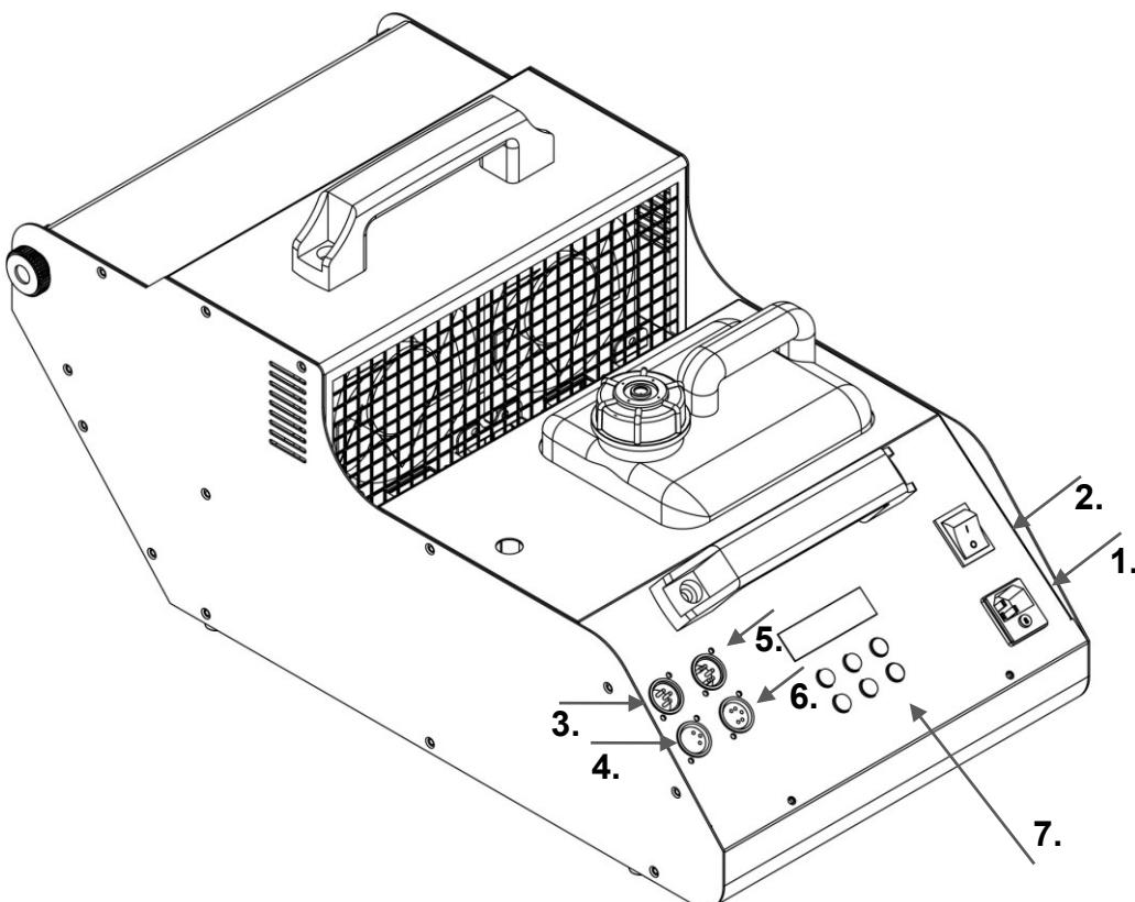
**1. POWER IN:** входной разъем питания IEC переменного тока с предохранителем F6,3AL230V.
