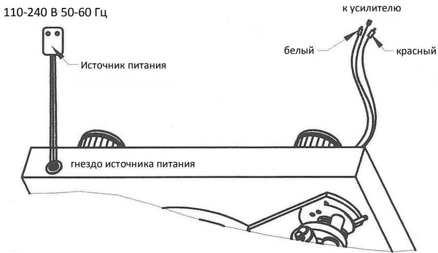
В комплект поставки проигрывателя грампластинок входит блок питания, подходящий для электрической сети вашей страны. Проверьте параметры электропитания, указанные на заводской табличке, чтобы убедиться в их соответствии параметрам электрической сети в вашем доме. Подключите разъём низкого напряжения блока питания к гнезду на задней панели проигрывателя грампластинок перед подключением блока питания к электрической сети.
