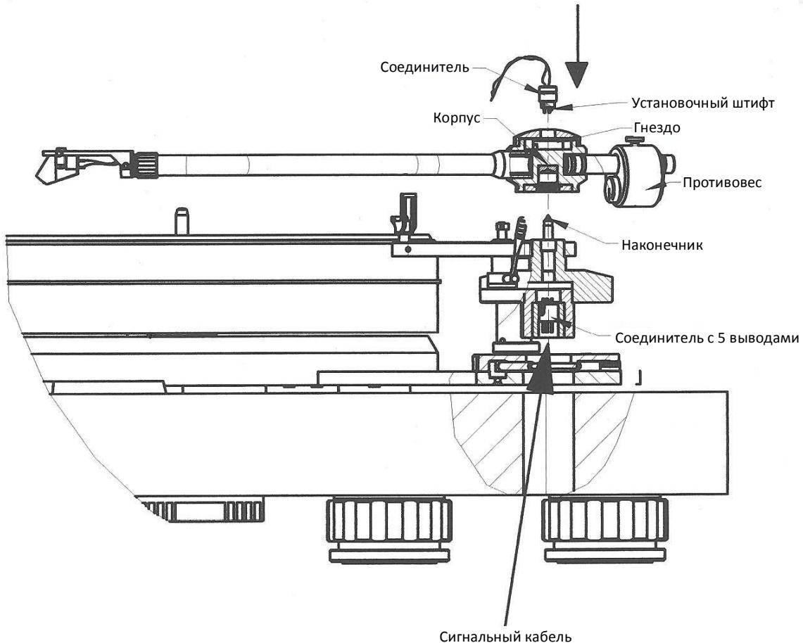
Осторожно вставьте выходной соединитель в гнездо в корпусе.
