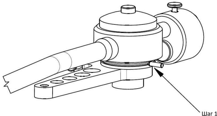
**Шаг 2:** установите нить в требуемое положение в канавке тонарма.
