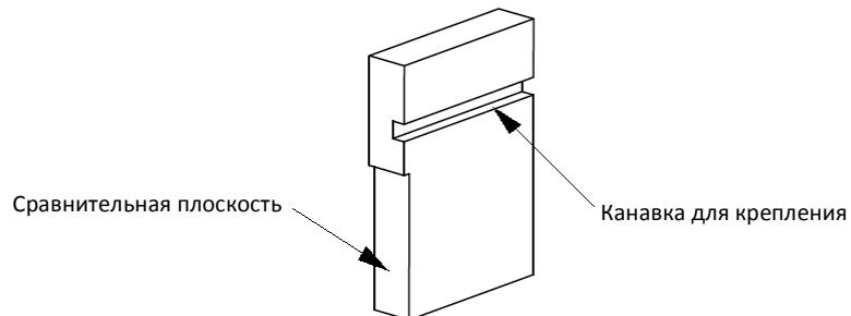
**Шаг 1:** установите инструмент так, чтобы канавка была направлена в сторону держателя, как показано на рисунке.
