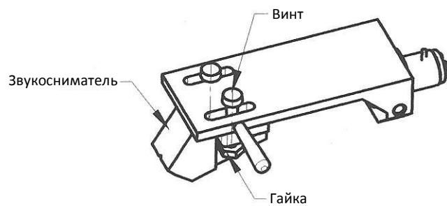
Для сборки звукоснимателя используйте крепежные детали из принадлежностей звукоснимателя.
