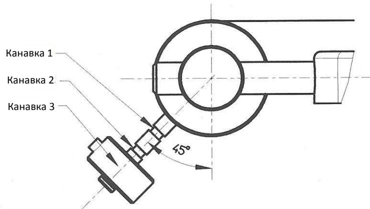
С помощью ползунка регулировки противоскатывающей силы отрегулируйте положение тонарма под углом 45 градусов.
