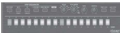
Кнопки STEP [1] – [16] показывают состояние соответствующего шага в выбранном диапазоне (STEP: 1 – 16, 17 – 32, 33 – 48, 49 – 64).
