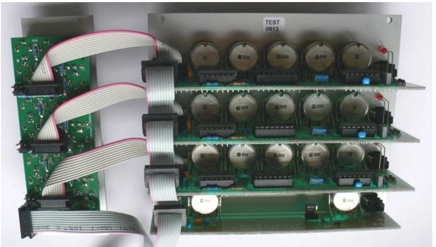
mit Stromversorgungskabel (3 x JP1 LFO/Filter-Platine A-127 Hauptmodul mit aufgestecktem Kabel) with power supply cable (3 x JP1 LFO/filter board A-127 main module with connected cable)
