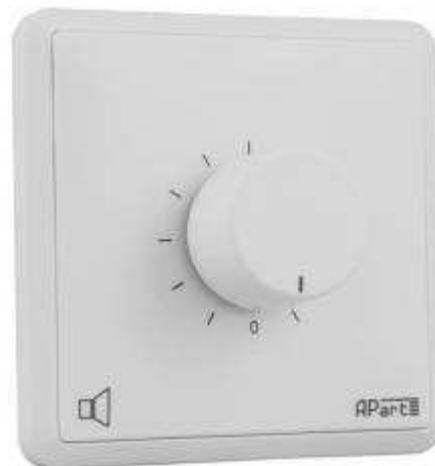
APart E-VOL40 имеет реле обхода с управляющим напряжением 24 В. Эта функция позволяет подать аварийный сигнал даже в том случае, если регулятор громкости установлен в положение "0".
