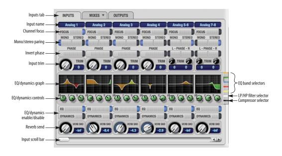
Figure 9-3: The Inputs tab.
